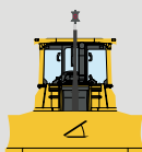
Konfiguracija s totalnom stanicom
