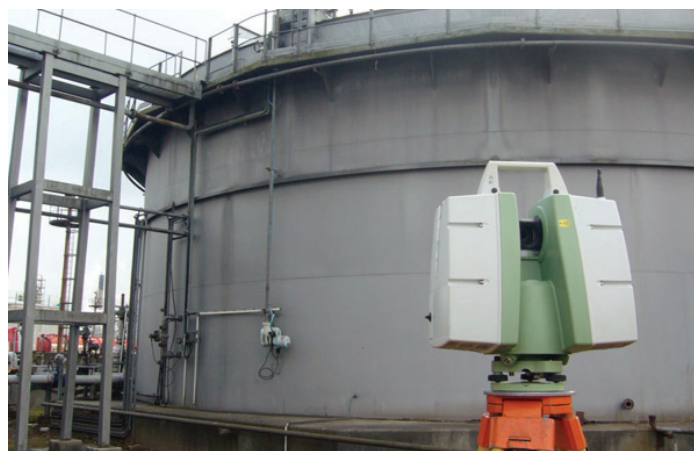
Leica SC P20 prilikom etaloniranja vertikalnog rezervoara
